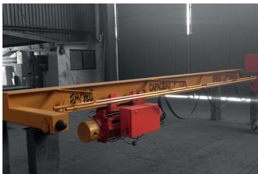
Puente de Viga I Weitflansch
