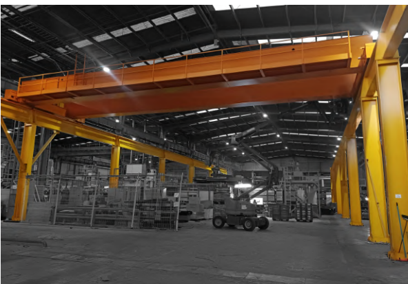
Grúa de dos puentes
