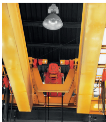
Carro adecuado para alturas reducidas
