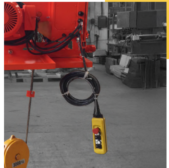
Botonera con cable colgada del carro o del polipasto.
